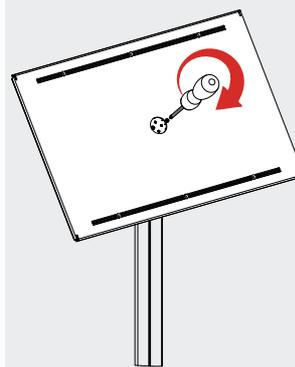
Für die Umstellung von horizontal auf vertikal (und umgekehrt) einfach die Schrauben lösen und in der neuen Position wieder fixieren.
