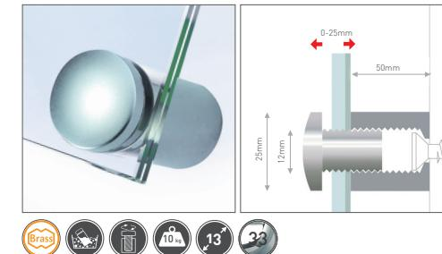
Schraubensysteme - die große Auswahl. Fisso Mix bietet die praktische Lösung Plattenmaterial an schwer zugänglichen Orten wie Nischen zu montieren. Halter wandmontieren, Kopf durch das Panel stecken und in den Halter schrauben. Material: Messing silbermatt veredelt.
