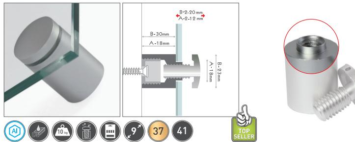
Elegantes Schraubensystem aus Alu. Halter wandmontieren. Bequem: Paneel auf die Auflage der Hülse legen, Kopf durch das Panel in den Halter schrauben. Seitliche Lochbohrung für Verschrauben des Kopfes. Fingerabdruck-resistant. Befestigung: Schraubensystem, frontale Montage manipulationsgeschützt dank Linksgewinde. Material: eloxiertes Aluminium in silber-matt.
