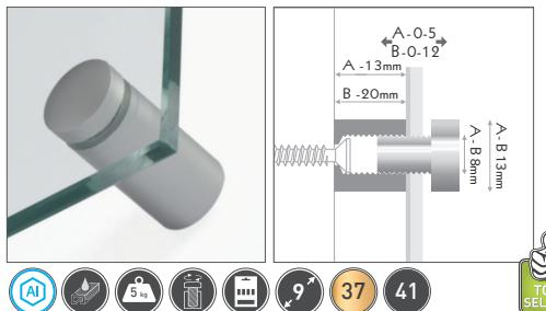
Elegantes Schraubensystem aus Alu. Halter wandmontieren, Kopf durch das Panel in den Halter schrauben. Seitliche Lochbohrung für Verschrauben des Kopfes. Fingerabdruck-resistant manipulationsgeschützt dank Linksgewinde. Befestigung: Schraubensystem, frontale Montage. Material: veredeltes Aluminium in silber-matt.
