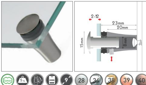
Revolutionäres Steck-Klemmsystem mit Manipulationsschutz. Dank des speziellen Designs genügen wenige Umdrehungen der Madenschraube, der Halter wird in die Hülse aufgespreizt und gesichert. Elastische Beilagscheiben für satte Auflage. Material: veredelter Metalldruckguss.
