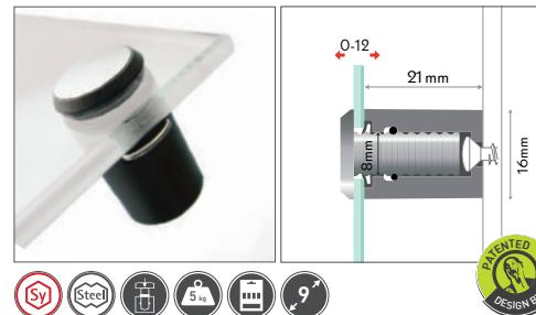
Variables Raster-Klemmsystem mit Stahl-Effekt, wetterfest. Das gebürstete Edelstahl-Inlay im Kopf verleiht effektvolle Optik und kann mit Druck oder Aufkleber personalisiert werden. Material: mattschwarzes Nylon, gebürsteter Edelstahl.
