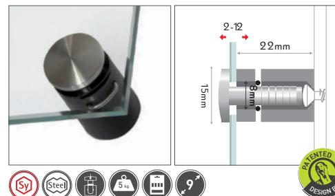
Variables Raster-Klemmsystem mit Edelstahl-Kopf. Alle Vorteile des Fixxo-Systems. Kopf aus Edelstahl, Hülse aus Kunststoff. Material: mattschwarzes Nylon, Edelstahl.
