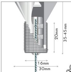
Seilhalter, Schraub-Spannsystem. Universelle Befestigung für Stahlseil, Kette, oder Nylonschnur. Halter montieren, Seil mit Madenschraube sichern, durch verschrauben der Hülse stufenlos spannen. Max. Ø1,8mm. Material: veredeltes Messing.
