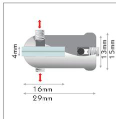
Seitlicher Paneelhalter für Stahlseil. Befestigung von Paneel und Seil mit Madenschrauben. Seilstärke: max. Ø1,8mm. Material: veredeltes Messing.
