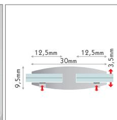
Doppel-Ablagenhalter für Seil, Schraubsystem. Fachböden am Stahlseil schnell und sicher befestigen. Seil durchziehen, mit Madenschraube sichern. Seilstärke: max. Ø1,8mm. Material: veredeltes Messing.
