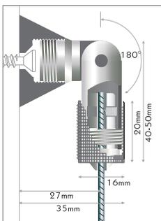
Seilhalter, Schraub-Spannsystem, klappbar. Befestigung für Seil, Kette, oder Nylonschnur. Halter montieren, Seil mit Madenschraube sichern, durch Verschrauben der Hülse stufenlos spannen. Besonders für Wandbefestigung geeignet. Seilstärke: max. Ø1,8mm. Material: veredeltes Messing.
