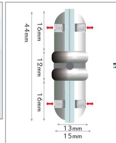
Paneelhalter für Seil, beidseitig. Seitlicher Halter für zwei Paneele am Stahlseil. Befestigung von Paneel und Seil mit Madenschrauben. Seilstärke: max. Ø1,8mm. Material: veredeltes Messing.
