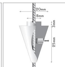
Ablagenhalter für Seil, Schraubsystem. Fachböden am Stahlseil schnell und sicher befestigen. Seil durchziehen, mit Madenschraube sichern. Seilstärke: max. Ø1,8mm. Material: veredeltes Messing.
