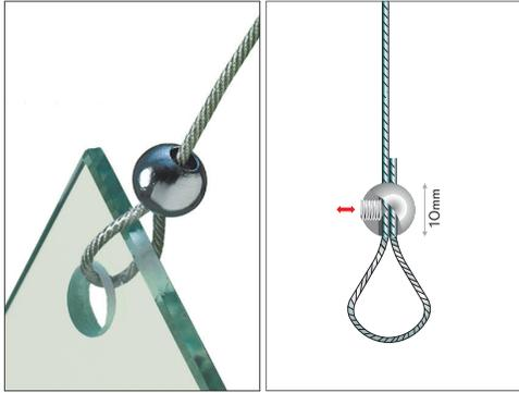
Schlaufenklemme für Seil, Stahlseil oder Nylonschnur zur Schlaufe durchschieben und mit Madenschraube sichern. Material: Messing verchromt. Seilstärke: max. Ø1,8mm.
