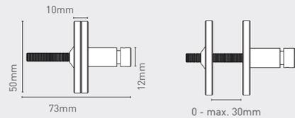
Für Paneele bis max. 30mm Stärke, bei stärkeren Paneelen einfach längeren Gewindestift verwenden.
