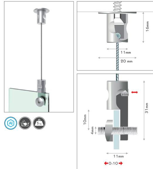
Für die Deckenabhangung komplettes Set: Ein Stück Seilhalterung für die Decke, ein Stück Paneelhalter für Seil, 2m Edelstahlseil mit Druckgussnippel. Der Paneelhalter befestigt Materialien diverser Stärken.
