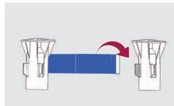
Den selbsteinziehenden Gurt einfach aus der Kassette ziehen und am nächsten Pfosten in die Halterung einschieben.
