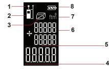
Display 1) Laser ON 2) Reference (front/rear) 3) Area / volume/ Pythagorean 4) Main line 1 5) Line 2 6) Line 3 7) Units 8) Battery level
