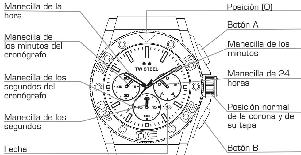
ajustar la manecilla de 5 centésimas del cronógrafo en la posición (0). La manecilla de los segundos del cronógrafo se puede avanzar rápidamente manteniendo pulsado los botones A o B. Una vez que las manecillas han vuelto a la posición (0), coloque la corona de nuevo en su posición normal y enrosque la tapa de la corona en el sentido de las manecillas del reloj.
