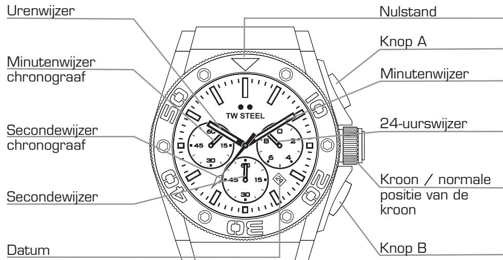
secondewijzer van de chronograaf kan snel worden rondgedraaid door knop A of B ingedrukt te houden. Zodra de wijzers naar de nulstand zijn teruggekeerd, duwt u de kroon in zijn normale stand terug en draait u de kroonkap rechtsom weer op de kast vast.
