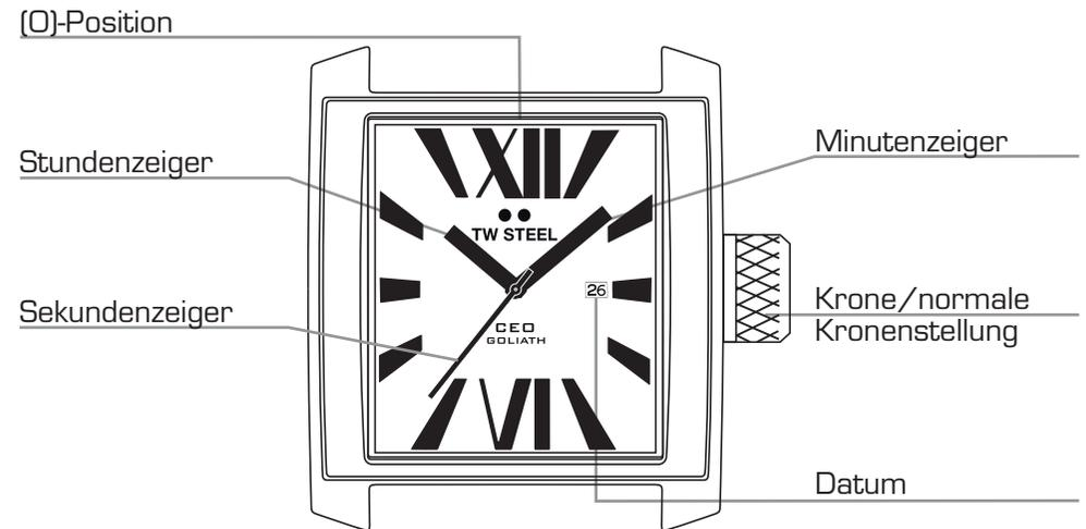
HINWEIS: WENN DIE KRONE NICHT RICHTIG EINGEDRÜCKT IST, IST DIE UHR NICHT MEHR WASSERDICHT UND KANN DAS UHRWERK ERHEBLICH BESCHÄDIGT WERDEN!
