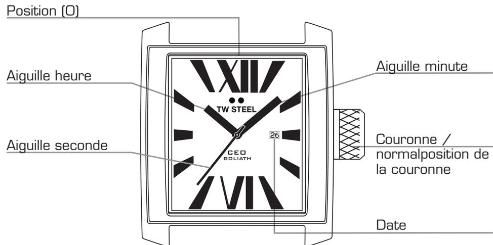
ATTENTION : SI LA COURONNE N'EST PAS RÉINSÉRÉE CORRECTEMENT, LA MONTRE N'EST PLUS ÉTANCHE ET LE MOUVEMENT PEUT ÊTRE SÉRIEUSEMENT ENDOMMAGÉ !
