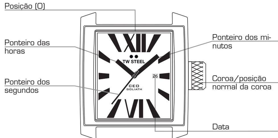
ATENÇÃO: SE A COROA NÃO ESTIVER BEM ENROSCADA, O RELÓGIO DEIXA DE SER À PROVA DE ÁGUA E O MECANISMO PODE SOFRER DANOS IRREPARÁVEIS!
