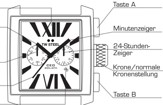
A ständig, um den Sekundenzeiger in die Position (0) zu stellen. Der Sekundenzeiger des Chronographen kann schneller bewegt werden, indem Sie die Taste A eingedrückt halten. Sobald sich der Zeiger wieder in der (0)-Position befindet, drücken Sie die Krone in ihre ursprüngliche Position zurück.
