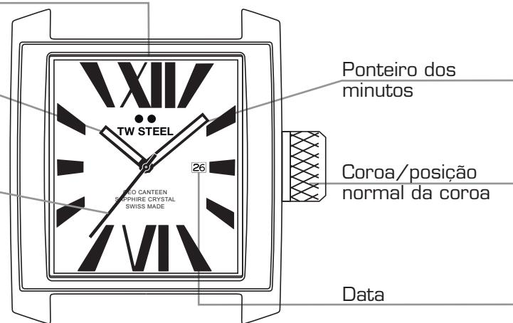
ATENÇÃO: SE A COROA NÃO ESTIVER BEM ENROSCADA, O RELÓGIO DEIXA DE SER À PROVA DE ÁGUA E O MECANISMO PODE SOFRER DANOS IRREPARÁVEIS!
