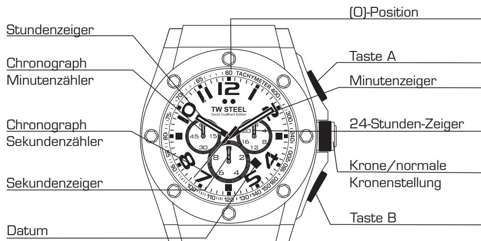
Chronographen zurücksetzen. Alle Zeiger kehren dann zur (0)-Position zurück. Der Sekundenzeiger des Chronographen kann durch nochmaliges Drücken der Taste B neu gestartet werden.
