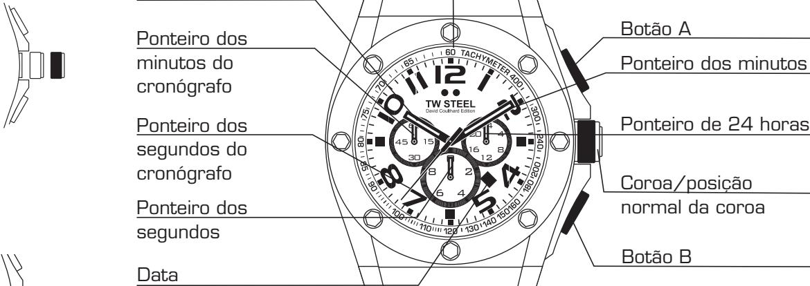
no botão B, reinicia o cronógrafo. Todos os ponteiros voltam então à posição (0). Se carregar novamente no botão B, volta a pôr o ponteiro dos segundos do cronógrafo a andar.
