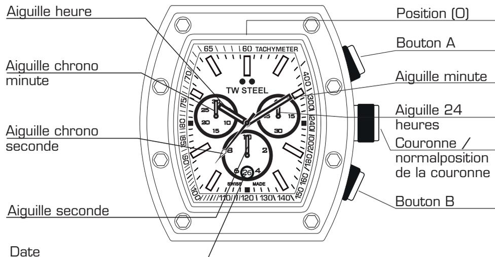
reprendre votre mesure, appuyez à nouveau sur B. Les aiguilles se calent automatiquement sur le temps correct, le chronomètre ayant continué de compter en arrière-plan. Vous pouvez réitérer cette action aussi souvent que nécessaire. Appuyez sur le bouton A pour interrompre le temps - le temps final sera alors affiché. Si vous appuyez ensuite sur le bouton B, le chronographe sera réinitialisé et les aiguilles reviendront en position (0).
