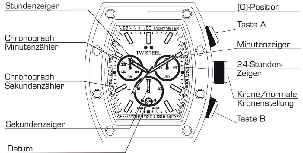
Taste B erneut – die Zeiger geben nun die korrekte Zeit an, die ständig im Hintergrund weitergelaufen ist. Sie können diesen Vorgang so oft wie nötig wiederholen. Drücken Sie zum Stoppen der Zeit die Taste A – die Endzeit wird nun angezeigt. Drücken Sie die Taste B, um den Chronographen zurückzusetzen und alle Zeiger in die Position (0) zu stellen.
