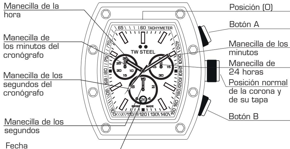
posición correcta, mostrando el tiempo correcto que se ha seguido cronometrando de forma inapreciable. Ese maniobra se puede repetir tantas veces como desee. Cuando desee detener la medición del tiempo, pulse el botón A. Se mostrará el tiempo final.
