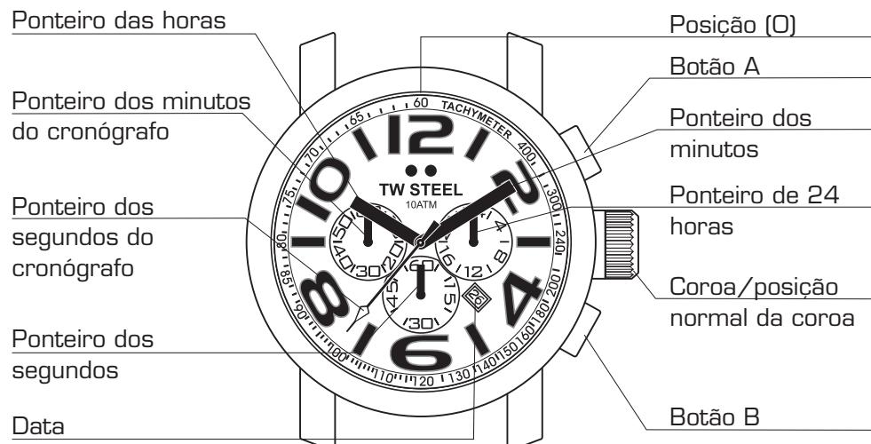
ATENÇÃO: SE A COROA NÃO ESTIVER BEM ENROSCADA, O RELÓGIO DEIXA DE SER À PROVA DE ÁGUA E O MECANISMO PODE SOFRER DANOS IRREPARÁVEIS!
