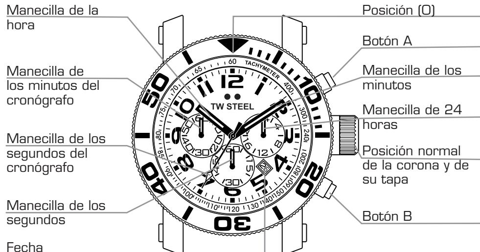
A. Una vez que la manecilla de los segundos del cronógrafo haya vuelto a la posición (0), coloque la corona de nuevo en su posición normal.
