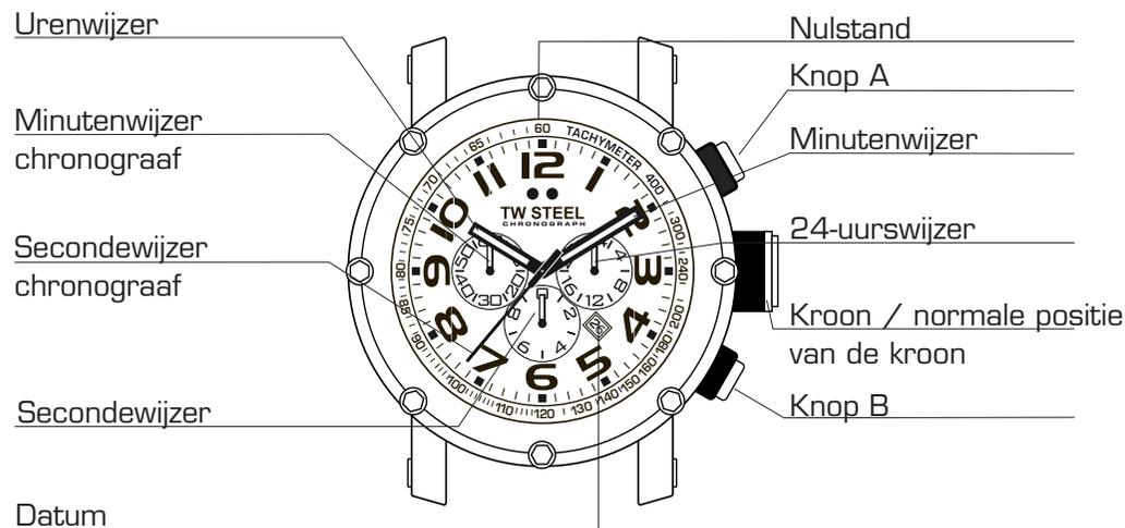
vervangen, moet u het volgende doen: Trek de kroon er tot de 2e stand uit. Druk op knop A om de secondewijzer van de chronograaf in de nulstand te zetten. Druk op knop B om de 1/20e-secondewijzer van de chronograaf in de nulstand te zetten. De wijzers van de chronograaf kunnen snel worden rondgedraaid door knop A of B ingedrukt te houden. Zodra de wijzers naar de nulstand zijn teruggekeerd, duwt u de kroon in zijn normale stand terug en draait u de kroonkap rechtsom weer op de kast vast.
