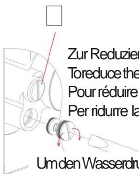
Zur Reduzierung des Wasserdrucks bis zum Absperren im Uhrzeigersinn drehen.
