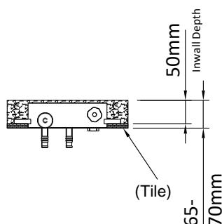
bevestig de inbouwbehuizing en sluit vervolgens de toevoerslang aan op het onderstaande deel
