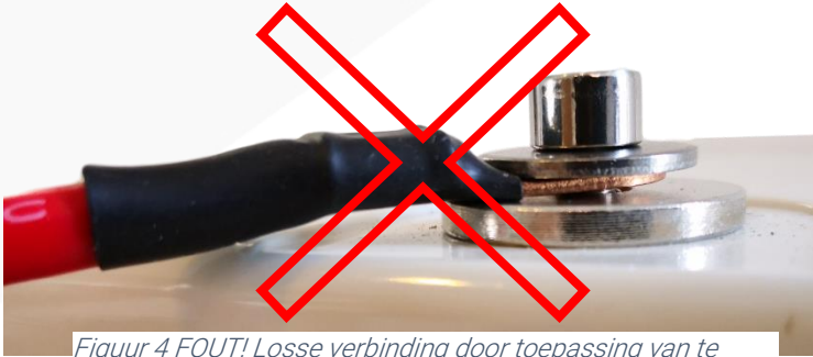
Figuur 4 FOUT! Losse verbinding door toepassing van te lange bout
