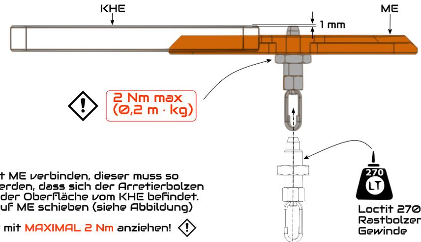
Rastbolzen mit ME verbinden, dieser muss so positioniert werden, dass sich der Arretierbolzen ca 1 mm unter der Oberfläche vom KHE befindet. Hierfür KHE auf ME schieben (siehe Abbildung)
