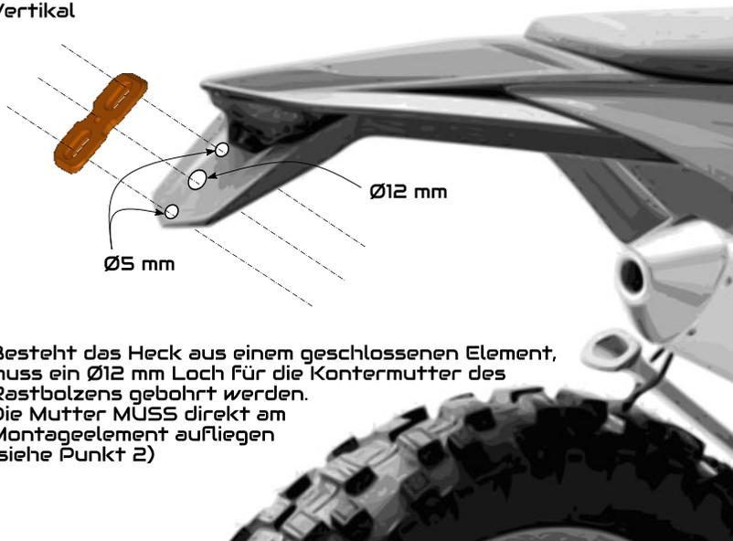
Besteht das Heck aus einem geschlossenen Element, muss ein Ø12 mm Loch für die Kontermutter des Rastbolzens gebohrt werden. Die Mutter MUSS direkt am Montageelement aufliegen (siehe Punkt 2)
