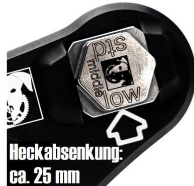
Nach der Wahl der entsprechenden Einstellung muss die Mutter an der Verstelle schraube mit **80Nm** angezogen werden.
