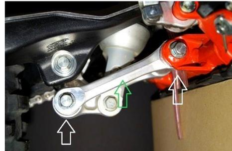
Entfernen Sie die Lagerbuchse und Dichtscheiben aus der originalen Umlenkung.
