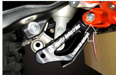
Montieren Sie die Verstelle schraube des **FlexibleLinkage** am Dreipunktlenker. Achten Sie hierbei auf die korrekte Lage der Verstelle schraube zur Lagerbuchse.
