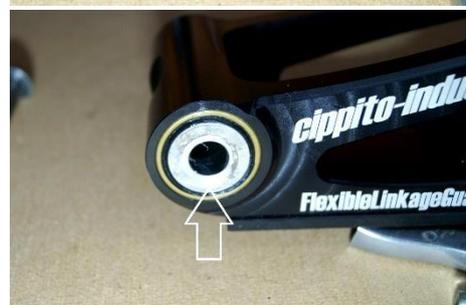
Entfernen Sie die Lagerbuchse sowie die Dichtscheiben aus dem Dreipunktlenker.
