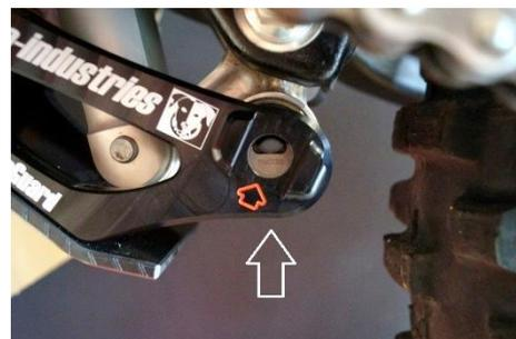
Durch ein Verdrehen der Verstelle schraube auf die entsprechende Stellung, kann nun die gewünschte Einstellung am **FlexibleLinkage** gewählt werden.
