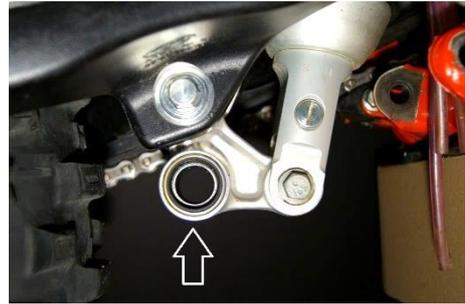
Fetten Sie die Lager und Dichtungen am Dreipunktlenker mit einem geeigneten Lagerfett und montieren Sie die Lagerbuchse
