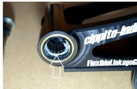
Montieren Sie die originale Lagerbuchse und Dichtscheiben in den **FlexibleLinkage**
