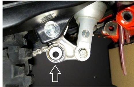
und Dichtscheiben des **FlexibleLinkage** in den Dreipunktlenker. Achten Sie hierbei auf die korrekte Lage der Bauteile.
