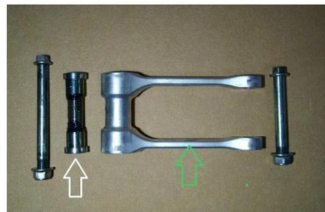
Fetten Sie die Lager und Dichtungen des **FlexibleLinkage** vor der Montage mit einem geeigneten Lagerfett.
