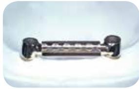
Kürzen Sie den Steg auf die gewünschte Länge, so dass Sie nur eine geringe Lötnaht benötigen. Löten Sie vorzugsweise mit CEKA SOL FILIGRAN (gelb, 780-820 °C) oder CEKA SOL W (weiß, 865-930 °C). Um eine optimale Härte zu erreichen, vergüten Sie 60 Minuten lang auf 400 °C. Setzen Sie den Reiter auf den Steg. Verwenden Sie Längen von mindestens 8 mm. Die ovalen Stege sollten stets mit Platzhalter verwendet werden.
