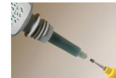
Sichern Sie das Gewinde der Patrize mit **CEKA BOND**, um die ungewollte Lockerung zu verhindern. Tragen Sie beim endgültigen Anbringen eine kleine Menge auf das Gewinde auf und entfernen Sie es nicht.
