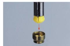
Legen Sie das Gehäuse auf eine ebene Fläche. Setzen Sie die gelbe Kunststoffmatrize auf den Eindruckstift und drücken Sie sie in das Gehäuse.
