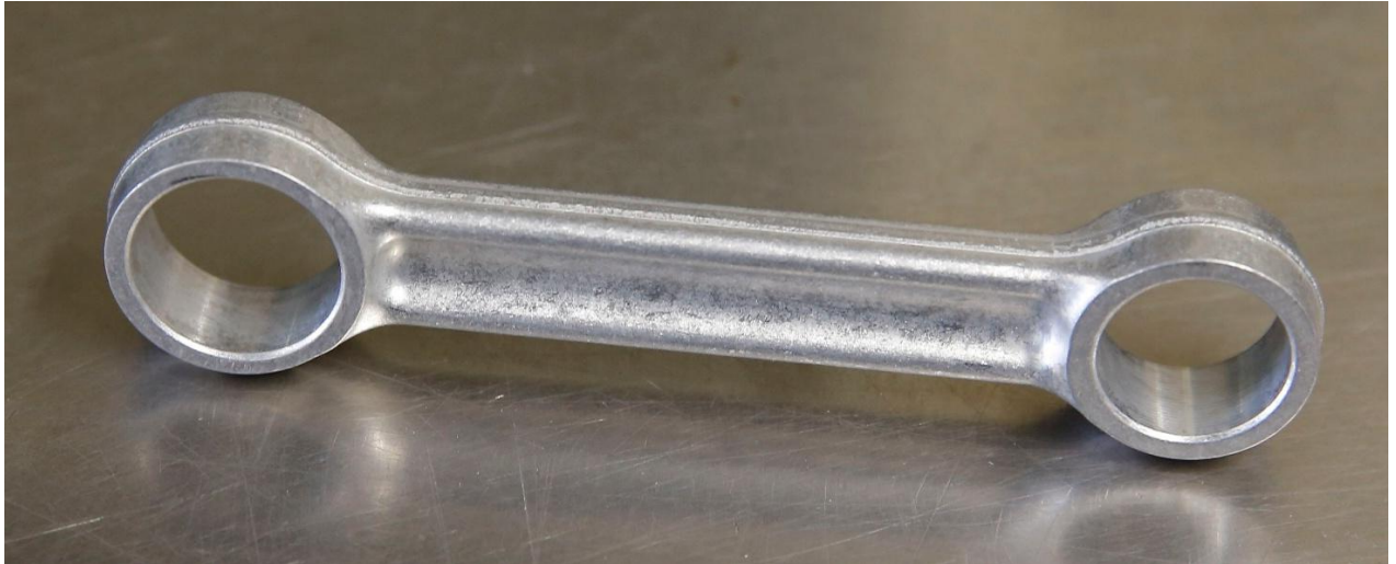
Biela leve melhorada. Graças à nervura, é 25 por cento mais resistente.
