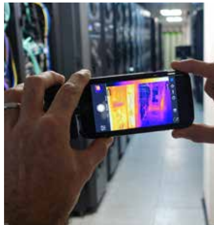
De FLIR ONE Pro laat zien hoe de watergekoelde deuren op efficiënte wijze warmte afvoeren aan de achterzijde van de racks.
