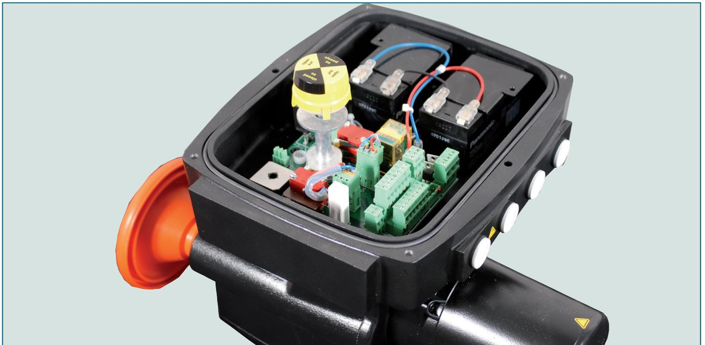
Bei Stromausfall fährt dieser Antrieb eine definierte Notposition an.
