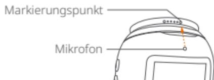
2. Halten Sie die Dashcam fest und drehen Sie sie gegen den Uhrzeigersinn, bis das Mikrofon an dem großen Markierungspunkt auf der linken Seite der Halterung ausgerichtet ist. Damit ist die Dashcam an der Halterung fixiert.
