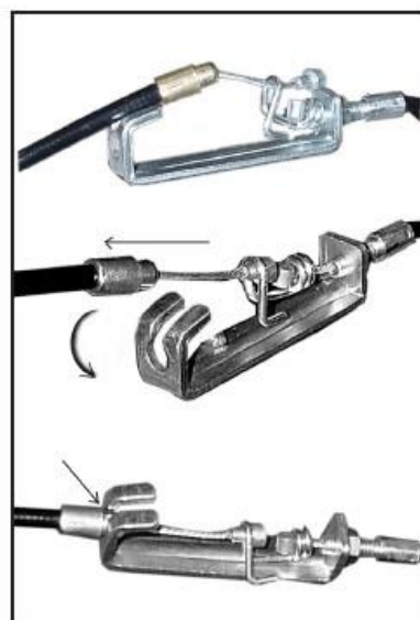
Opération de montage du câble avec son accroche
