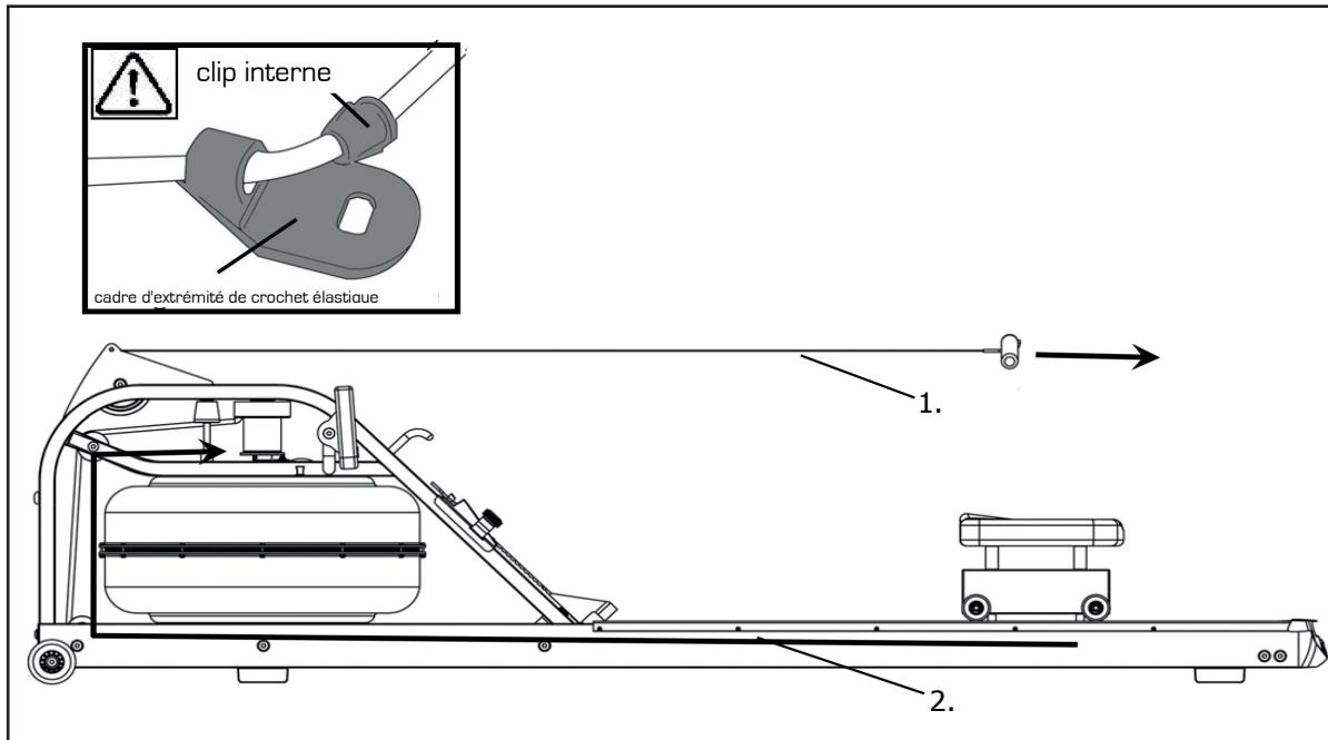
Décrocher le cordon de choc élastique de la jambe arrière. Ensuite, poussez le clip intérieur du cadre d'extrémité du crochet élastique. Tirez le Bungee à travers le clip interne jusqu'à ce qu'il soit libre. Cela permettra au fil de choc Bungee d'être complètement vissé hors du cadre principal et jusqu'à la poulie Bungee Belt où il sera ré-attaché une fois que la rampe de rampe est dans la bonne position.
