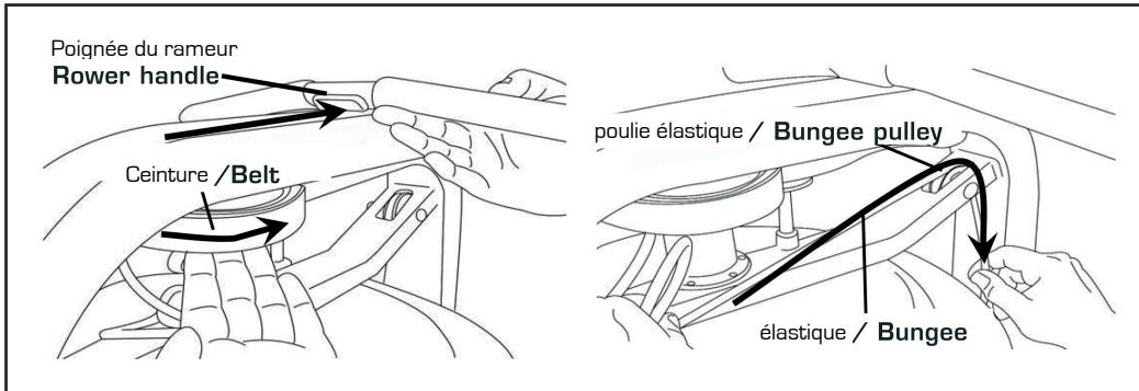
3. Enroulez la courroie sur la poulie à courroie / poulie élastique jusqu'à ce que la poignée du rameur soit le plus en avant possible.
