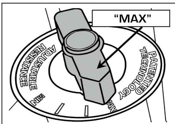
Lors du remplissage du réservoir AR, la poignée de réglage doit être réglée sur la position "MAX" comme indiqué, pour permettre de remplissage des niveaux précis. L'utilisation de tout autre réglage que «MAX» entraînera des niveaux de remplissage imprécis et, dans des cas extrêmes, des fuites peuvent se produire pendant l'utilisation ou en position debout.
