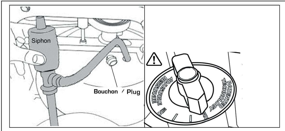
1. Régler la poignée de l'ajusteur sur "MIN"
