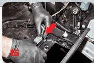
DISCONNECT THE DOOR LOCKING SWITCH CLIP FROM DOOR PANEL.
