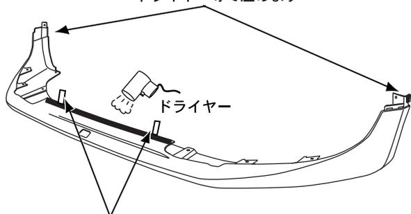
両面テープの剥離紙を剥がし折り曲げておき、ドライヤー等で温めます
