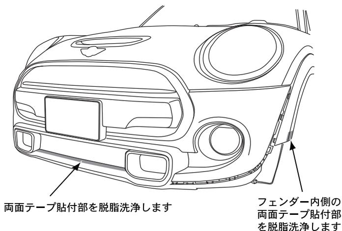
フェンダー部分の両面テープの剥離紙は、全て剥がしておき、ドライヤー等で温めます
