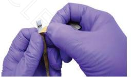
REMOVE THE TOP PAPER LAYER FROM THE BACK OF THE LED STRIP TO EXPOSE THE ADHESIVE
