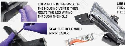
USE ORACLE HEADLIGHT SEALANT TO FORM A STEADY BEAD AROUND THE ENTIRE FOG LIGHT.
