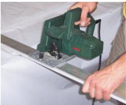
Die Verlegeprofile werden auf die gewünschte Länge zugeschnitten.
