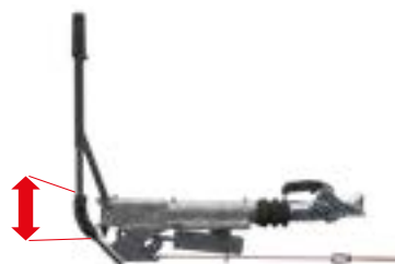
Handbremshebel geschlossen (Standbremse rückwärts, Bremse optimal eingestellt)
