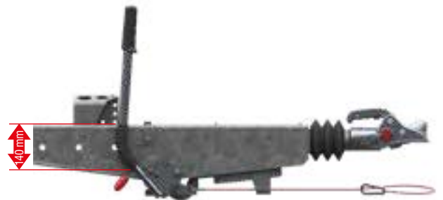
Handbremshebel geschlossen (Standbremse rückwärts, Bremse optimal eingestellt)
