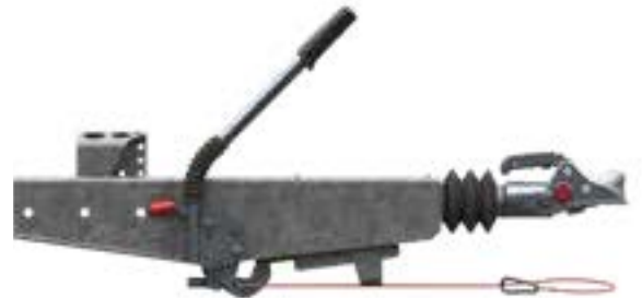
Handbremshebel geschlossen (Standbremse vorwärts)
