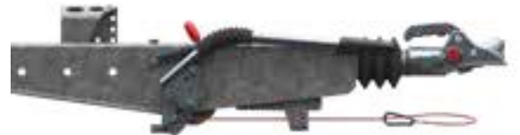
Handbremshebel geöffnet (Fahrbetrieb)
