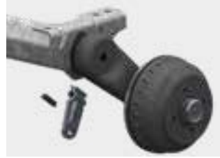
Steckbarer Stoßdämpferhalter. Bei Achsen mit Stabilformschwinghebel. Somit problemlose Nachrüstung ohne Schweißen.
