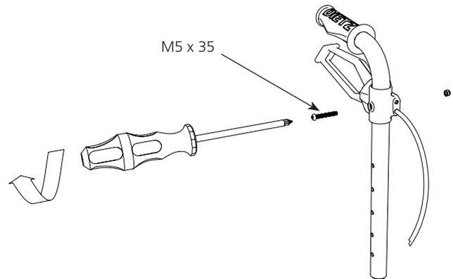
Befestigen Sie nun den Rückengurt, zusammen mit dem Bremshebel mit der mitgelieferten, längeren Schraube (M5 x 45mm) und abgerundeten Scheibe.
