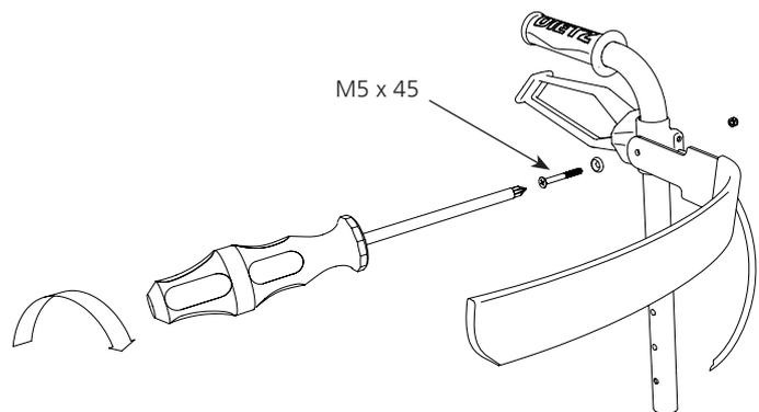
Befestigen Sie Rückengurt und Bremshebel entsprechend auf der anderen Seite, und versichern Sie sich, dass alle Schraubverbindungen wieder fest angezogen sind. Überprüfen Sie auch die Bremsen auf einwandfreie Funktion.
