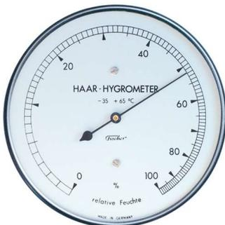
Zur Bestimmung der relativen Luftfeuchtigkeit wird bei unseren Haarhygrometern ein Menschenhaar als Messelement verwendet. Durch eine Spezialbehandlung wird bewirkt, dass es fast trägheitsfrei auf Feuchteänderungen reagiert (außer bei plötzlichen Temperaturwechsel). Haarhygrometer sind einsatzfähig in einem Temperaturbereich von  $-35$  bis  $+65^{\circ}\text{C}$ . Bei Dauereinwirkung von Temperaturen über  $+65^{\circ}\text{C}$  wird das Haar im Laufe der Zeit funktionsuntüchtig.
