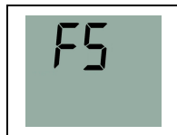
Displayanzeige nach Tastendruck. FS = Factory settings (Werkseinstellungen)
