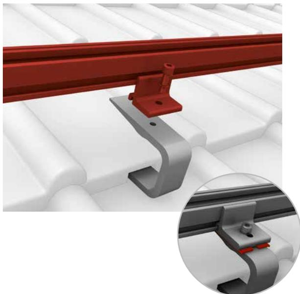
Die Montageschiene wird auf dem Dachhaken mit Hilfe des K2 Climbers und der Zylinderschraube mit Unterkopfverzahnung montiert. Anzugsdrehmoment 16 Nm.
