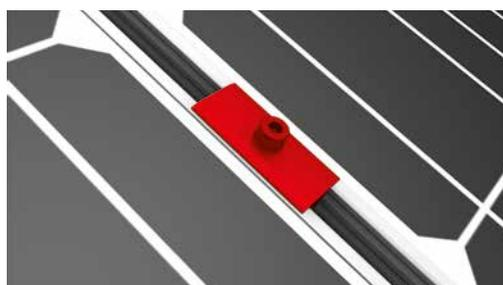
Alternativ: Zwischen zwei Modulen jeweils zwei XS Mittelklemmensets verwenden. Anzugsdrehmoment: 14 Nm
