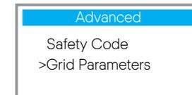
Beachten Sie, dass bei einem Ausfall der DSP-Kommunikation des Wechselrichters alle erweiterten Einstellungen ausgeblendet werden.
