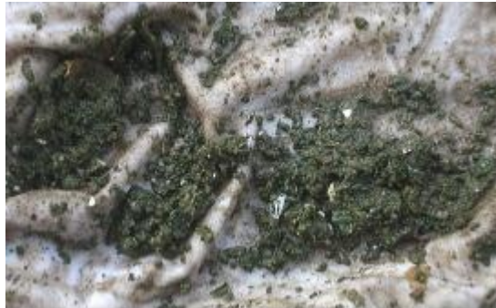
( Pic.5.3.1 ) Verschmutzter Filter
