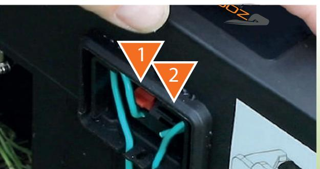
Bij het aansluiten op het oplaadstation is er een IN gang (rood) en UIT (zwart) gang voor de grenskabel. De kabel die onder het oplaadstation doorgaat moet worden aangesloten op de ingang dus rode aansluiting.
