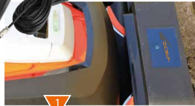
\* Retirez le câble périphérique de l'entrée IN (connexion rouge). La LED clignote en vert et l'alarme s'éteint. Après 30 secondes, l'alarme s'arrête, mais la LED continue à clignoter. Ainsi, vous saurez s'il y a une rupture dans le câble.
