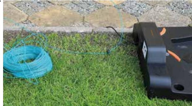
Vor der Ladestation sollten sich 2 Meter Freiraum befinden, um sicherzustellen, dass der Roboter immer richtig auf seine Ladestation zugreifen kann. Hinter der Ladestation befindet sich mindestens 1 Meter freier Platz. (keine Biegungen).
