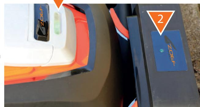
Opmerking; Als de LED langere periode blijft knipperen (langer dan 3 uur), dan kan er een slecht contact zijn tussen het oplaadstation en de robotmaaier. Maak dan de oplaadplaten van het oplaadstation en de maaier schoon. We adviseren deze regelmatig schoon te maken met een stukje staalwol of fijn schuurpapier.
