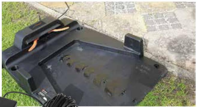
\* Remarque : Si la LED continue à clignoter pendant des périodes plus longues (plus de 2-3 heures), il peut y avoir un mauvais contact entre la station de charge et la tondeuse robotisée. Nettoyez ensuite les plaques de charge de la station de charge et de la tondeuse. Nous vous conseillons de les nettoyer régulièrement avec un morceau de laine d'acier ou du papier de verre.
