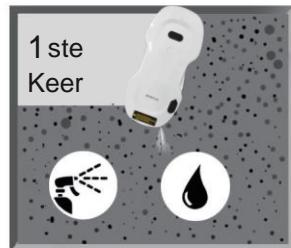
**Bij het slippen van de robot, dient u water op de doek te sputten.**
