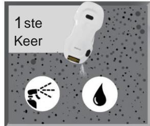
**Wenn der Roboter ausrutscht, sprühen Sie Wasser auf das Tuch.**
