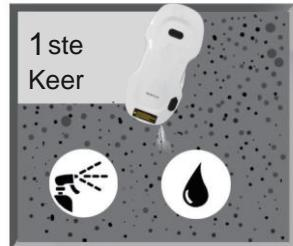
**Lorsque le robot glisse, vaporisez de l'eau sur le chiffon.**
