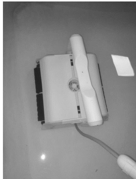
Wanneer u de robot uit het water haalt moet u de robot ongeveer 10-15 sec. boven het water houden om het water eruit te laten lopen. Houd alleen de bovenste handgreep vast en **trek nooit aan de stroomkabel**.
