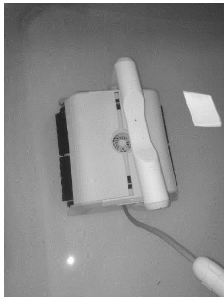
Wenn Sie den Roboter aus dem Wasser nehmen, müssen Sie den Roboter für etwa 10-15 Sekunden über dem Wasser halten, um das Wasser herauszulassen. Halten Sie nur den oberen Griff und **ziehen Sie niemals am Stromkabel**.
