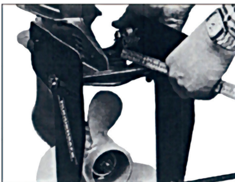
Fig. 7 Bevestig het tweede roerblad zoals onder Fig. 1 tot en met Fig. 6 beschreven staat. De plaats van de brackets op de cavitatieplaat dienen links en rechts gelijk te zijn.
