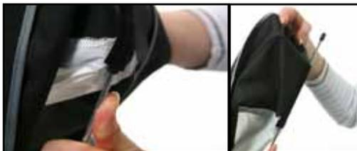
4. Auf der Innenseite der Diffuser-Ecken sind Taschen (aus Velcro Material) durch die, die Softboxstange durchgeführt wird.
