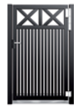
Modeno V60 Verticale lamellen - 60 x 20 mm - Tussenruimte ca. 25 mm Bovenzijde poort voorzien van kruizen - 300 mm hoog - 60 x 20 mm
