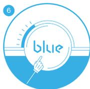
Presione el botón para encender la unidad. La unidad se configurará automáticamente con la velocidad de operación que tenga la mayor eficiencia energética. Cuando la luz del indicador se enciende de color blanco, significa que la unidad funciona correctamente.
