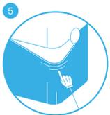
Vuelva a ajustar el prefiltro de tela sobre la porción inferior de la unidad, con las marcas de la tela ubicadas en las esquinas superiores.
