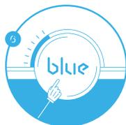
Drücken Sie zum Einschalten des Gerätes auf die Taste. Das Gerät stellt sich automatisch auf die empfohlene, energieeffiziente Betriebsgeschwindigkeit ein. Wenn die Kontrollleuchte weiß leuchtet, arbeitet Ihr Gerät einwandfrei.
