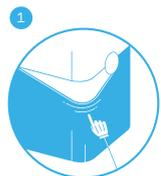
Retirez doucement le pré-filtre et détachez-le du fond de l'appareil pour le retirer.
