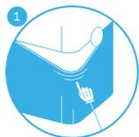
1 Delikatnie wyciągnij filtr wstępny z dolnej części urządzenia i odłącz go.
