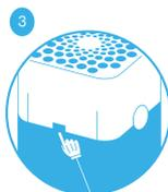
Avant de replacer le pré-filtre en tissu, appuyez doucement sur les boutons d'ouverture situés de chaque côté de l'appareil jusqu'à ce que vous entendiez un clic.
