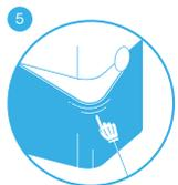
Reposez le pré-filtre en tissu sur la partie inférieure de l'appareil en plaçant les marques en tissu dans les coins supérieurs.
