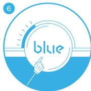
Appuyez sur le bouton pour allumer l'appareil. L'appareil se règle automatiquement sur la vitesse recommandée de fonctionnement à faible consommation électrique. Quand le voyant est blanc, l'appareil fonctionne correctement.
