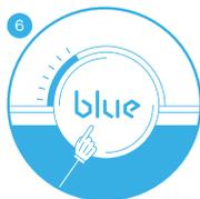
Naciśnij przycisk, aby włączyć urządzenie. Urządzenie automatycznie ustawi zalecaną szybkość w celu optymalizacji zużycia energii. Kiedy kontrolka świeci na biało, urządzenie pracuje poprawnie.
