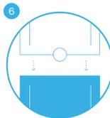
Para volver a colocar la parte superior de la unidad, presiónela con firmeza hasta escuchar un clic.
