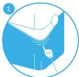
Zum Entfernen des Vorfilters ziehen Sie daran und lösen Sie ihn vorsichtig vom unteren Teil des Gerätes.
