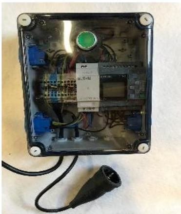
Biodrum 200 und Trommel 100 verfügen über einen zusätzlichen Steckeranschluss, beispielsweise für eine zusätzliche Spülpumpe (nicht im Lieferumfang enthalten). Dieser zusätzliche Steckeranschluss wird pro 20 Spülungen einmal eingeschaltet, um die Spülrinne zu spülen. Dies kann im Siemens Logo beispielsweise auf 1x pro 5
