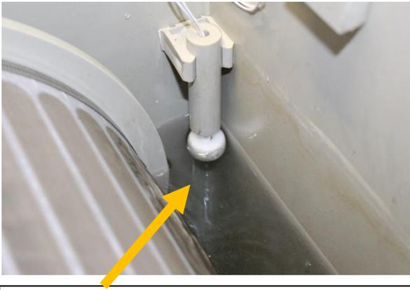
Der Schwimmer befindet sich in der Spülposition, die Teichpumpe ist eingeschaltet. Trommel läuft und die Spülpumpe spült die Gaze. Bleibt der Schwimmer 30 Sekunden in dieser Position, aktiviert die Elektronik den TROCKENLAUFMODUS.
