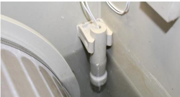
Der Schwimmer befindet sich in der „normalen“ Position, die Teichpumpe ist eingeschaltet.
