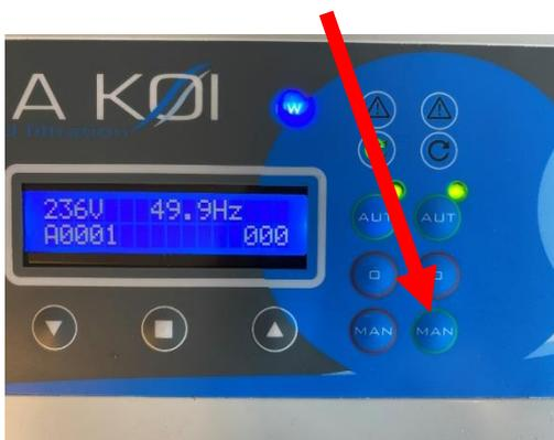
Wenn Sie diese Taste gedrückt halten, stoppt die Teichpumpe und der Motor und die Spülpumpe werden aktiviert. Wenn Sie es loslassen, wird das System
