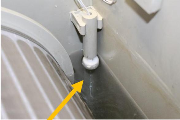
Der Schwimmer befindet sich in der Spülposition, die Teichpumpe ist eingeschaltet. Trommel läuft und die Spülpumpe spült die Gaze. Bleibt der Schwimmer 30 Sekunden in dieser Position, aktiviert die Elektronik den TROCKENLAUFMODUS.
