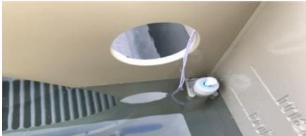
Der Schwimmer befindet sich in der „normalen“ Position, die Teichpumpe ist eingeschaltet.
