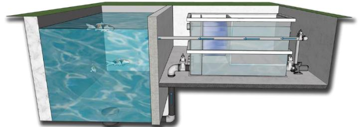
Trommel ausgerichtet sein. Der maximale und minimale Wasserstand ist auf der Innenseite des Filters angegeben, der tatsächliche Wasserstand sollte zwischen diesen Werten liegen, vorzugsweise so nahe wie möglich am maximalen Pegel (siehe Abbildung). Der Filter hat 110 mm Eingänge und 110 mm Ausgänge. Zusätzlich ist am Biodrum 30/40/80 auch ein Anschluss für die Spülpumpe vorgesehen
