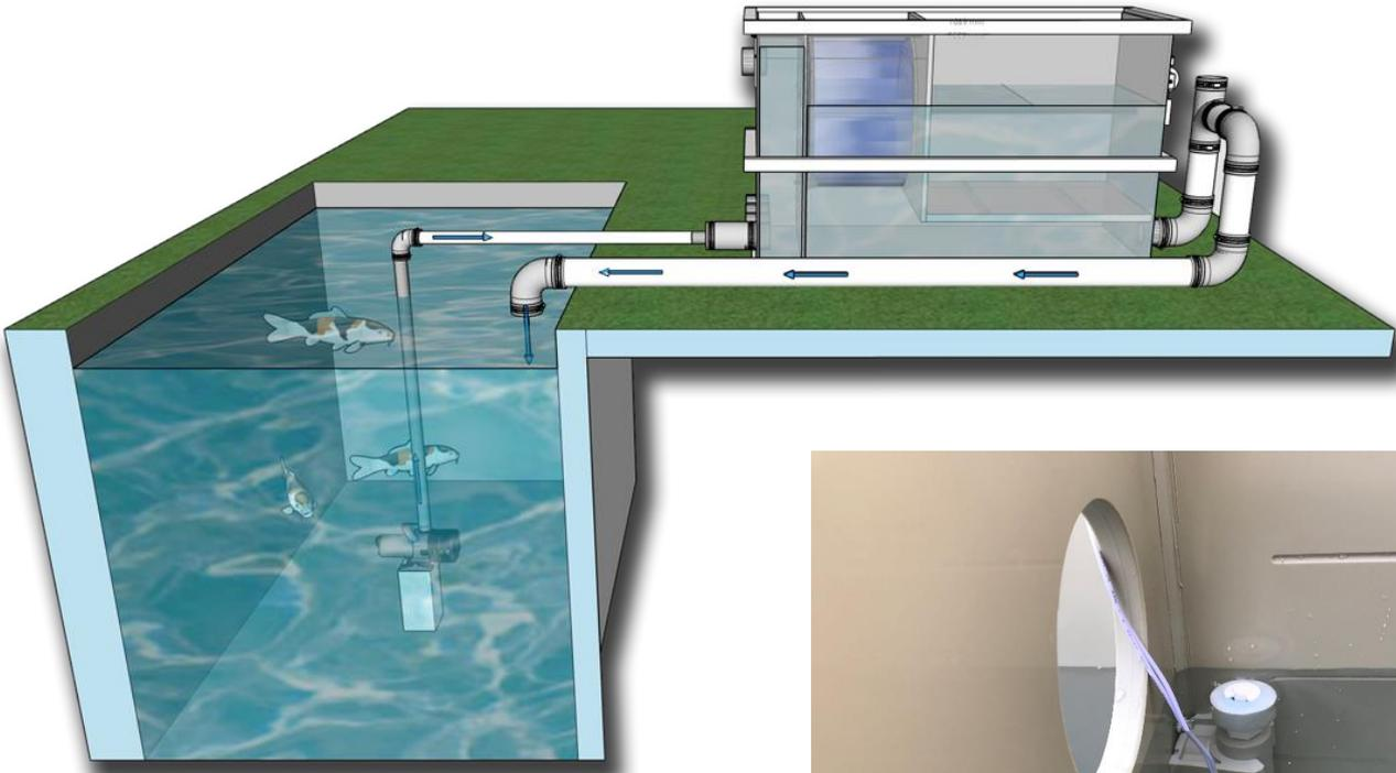
Die Ma-Koi-Trommelfilter und Biodrums können auch als gepumptes System angeschlossen werden. Das Wasser wird von der Pumpe in den Filter gepumpt. Nicht verwendete Öffnungen sollten dann abgedeckt werden.
