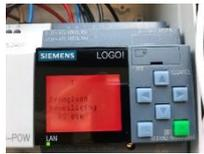
Trockenlaufmodus. Dies dient zum Schutz Ihrer Teichpumpe. Wenn sich der Schwimmer wieder in seiner normalen Position befindet (er schwimmt wieder, weil sich genügend Wasser im Filter befindet), schaltet sich die Pumpe nach 5 Minuten (Standardwert Makoi drum control) (makoi PF controller direct )wieder ein
